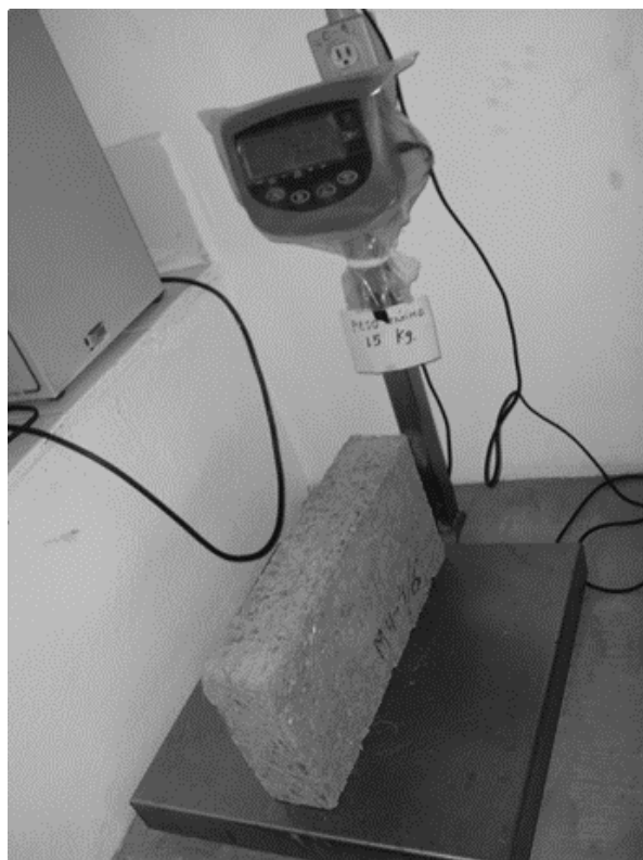
Figura 10. Pesado del block sólido del BRE en báscula digital, para registrar el peso de cada pieza.
