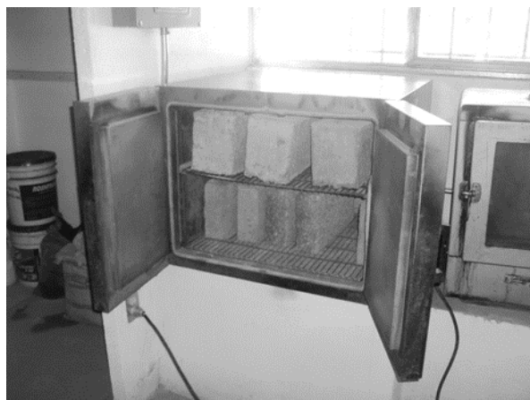
Figura 9. Vista del Horno Humbolt MFG CO, donde se desecaron las piezas del BRE para eliminar la humedad ambiental.
