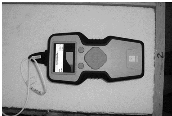
Figura 14. Vista de la caja térmica, con el equipo Meter trabajando en las pruebas térmicas del BRE.
