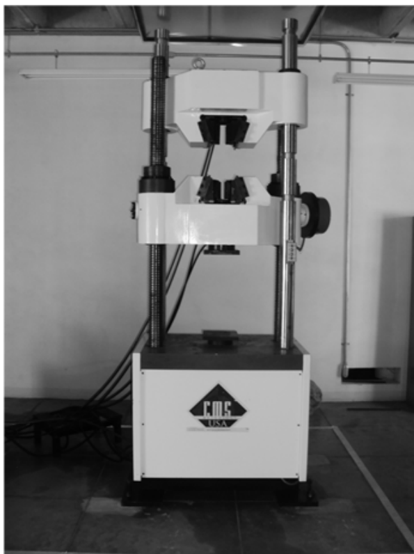
Figura 7. Vista de la Máquina de Ensayos CMS Metrology, con capacidad de carga de 1 000 kN.
