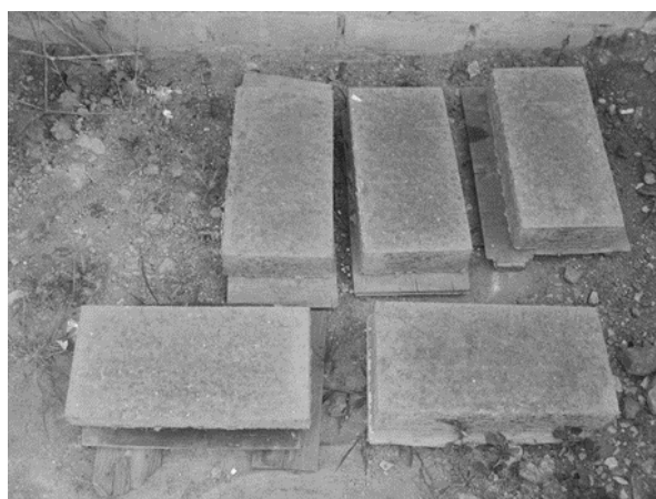
Figura 6. Bloques sólidos /BRE secándose al sol.
