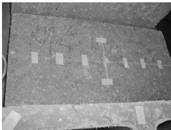
Figura 12. Vista de los puntos definidos para perforar en las piezas del BRE.
