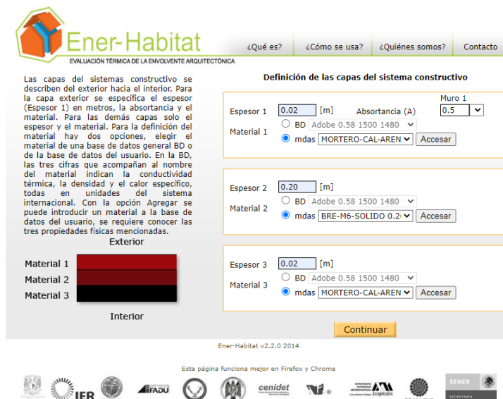
Figura 16. Vista del registro de datos en plataforma Ener Habitat, para correr las simulaciones térmicas del BRE versus adobe, block de concreto ligero y ladrillo rojo recocido.
