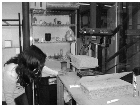
Figura 13. Vista del block sólido del BRE siendo perforado con el taladro de banco y las brocas de 1/16".
