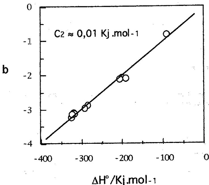
Figura 1. Dependencia lineal de la constante característica  $b$  del proceso de la solubilización de homopolímeros en función de la entalpía de Miscelización.  $b \approx C_2 \cdot (\Delta H^\circ \text{cop})$  donde  $C_2 \approx 0,01 \text{ kJ}^1 \text{ mol}$
