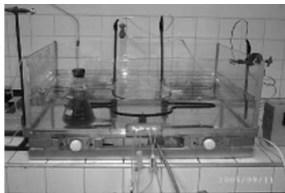
Figura 2. Batería de experimentación formación de biopelícula anaerobia.
