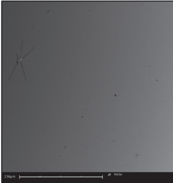
Figura 4. Estructura de recubrimiento SiTiZr (10-20-70) a 900 X.
