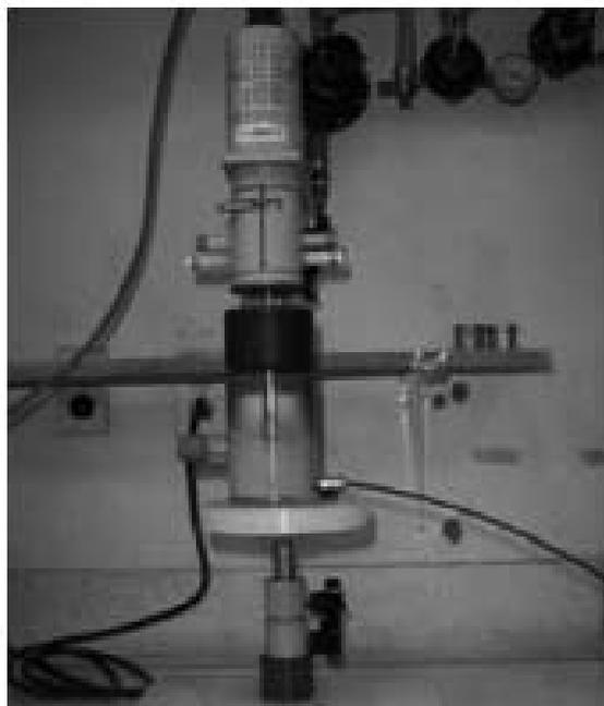
**Figura 2.** Celda empleada para ensayos de erosión.
