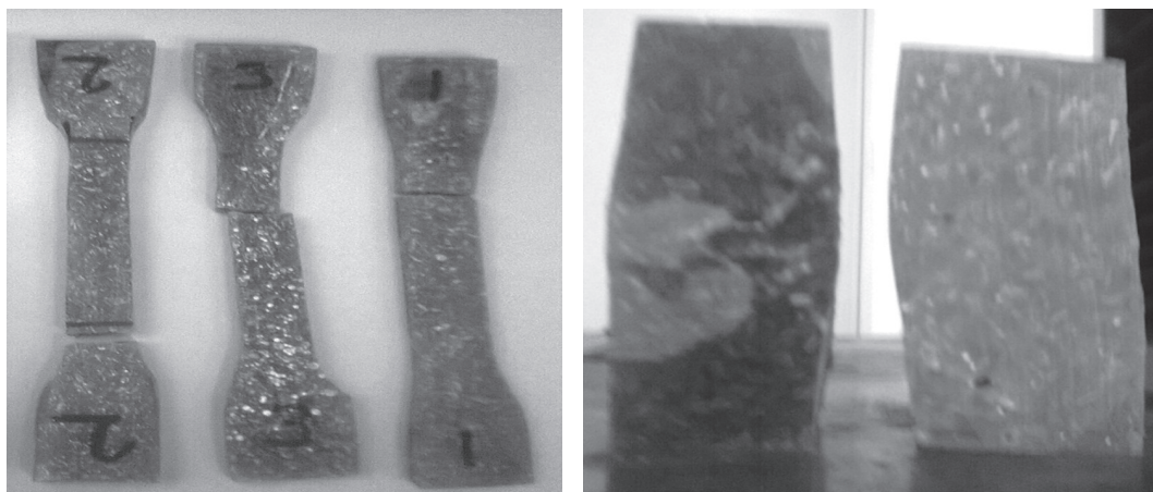
Figura 6. Probetas después de los ensayos de a) Tracción, b) Compresión.
