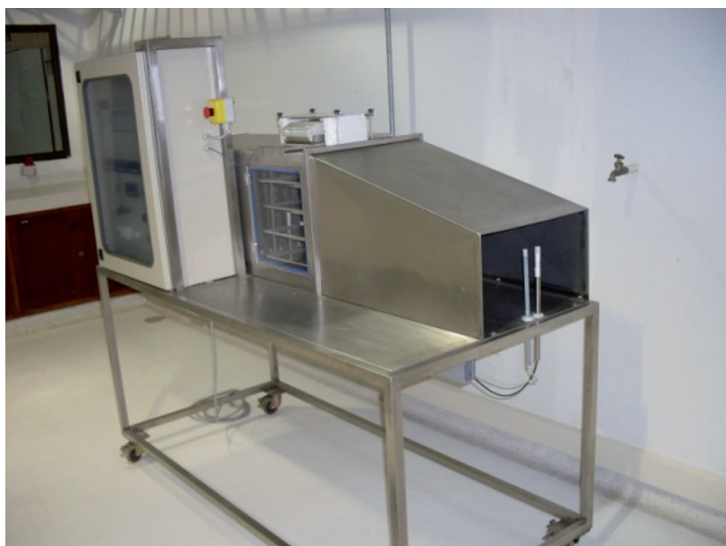
Figura 1. Secador de bandejas a escala de laboratorio.
