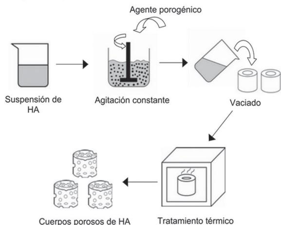
**Figura 7.** Esquema de fabricación de cuerpos porosos de HA usando la técnica de moldeo por barbotina.
