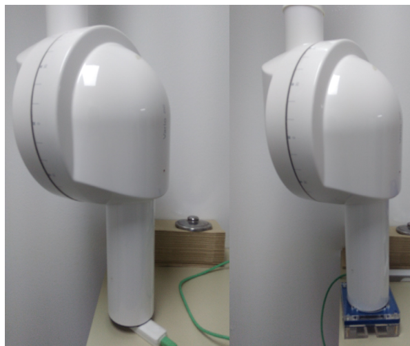
Figura 1. Montajes experimentales para las medidas de parámetros de exposición (izquierda) y calidad de imagen en equipos intraorales (derecha).
