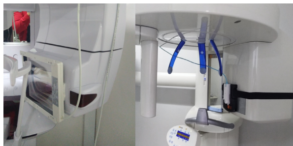
Figura 2. Montajes experimentales para las medidas de producto kerma aire-área, PKA, (izquierda) y parámetros de exposición en equipos de radiografía panorámica (derecha).
