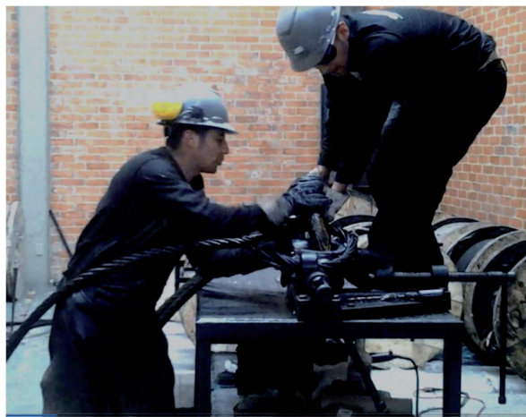
Figura 3. Ajuste en prensa de tres mordazas
