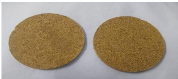
Figura 13. Aglomerado de aserrín de guadua hecho con el adhesivo de aceite de higuierilla. Fuente: elaboración propia.
