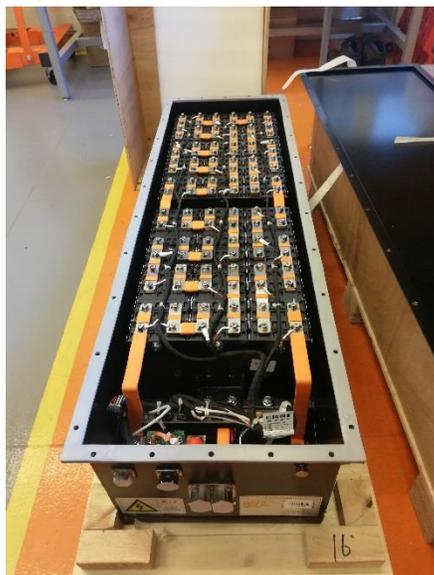
Figura 12. Banco de baterías ion litio de 96 v NCM Soundon New Energy, fabricado en China. Fuente: gentileza Inacap Proyecto Fondef ID 18/10379 Osorno-Chile.
