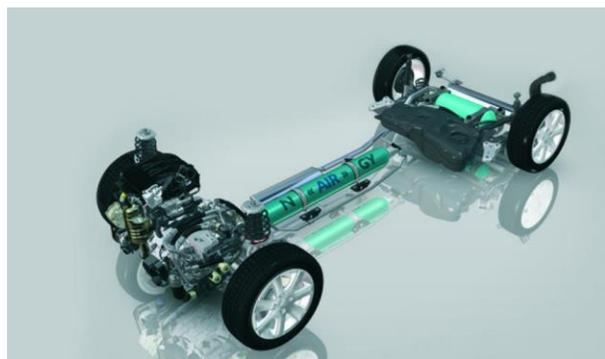
Figura 26. Planta motriz híbrida de PSA. Fuente: [12].
