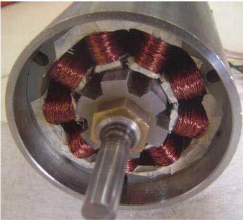
Figura 22. Máquina eléctrica (motor- generador), unidad desarmada para pruebas de laboratorio. Fuente: [17].
