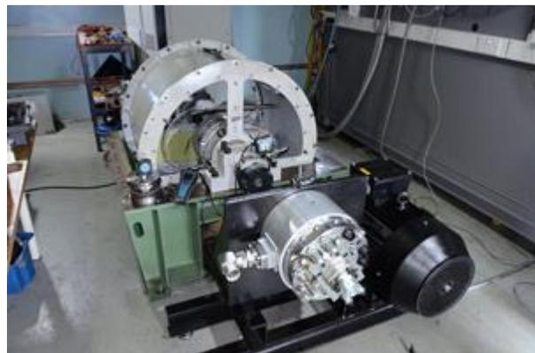
Figura 11. Modelo de KERS hidroeléctrico, banco de ensayo Ricardo. Fuente: empresa Ricardo.
