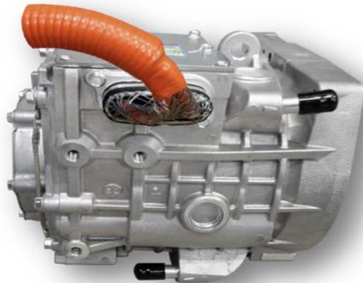
Figura 23. Máquina asincrónica con imanes permanentes modelo: Y51, Fuente: [12].
