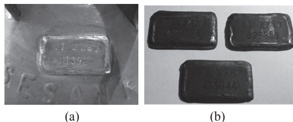
Figura 3. Placas estampadas. (a) Placa estampada y soldada en un cilindro. (b) Placas de diversas áreas.
