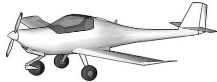
Figura 1. Configuración de tren de aterrizaje triciclo (Fuente: <http://www.pasionporvolar.com>).
