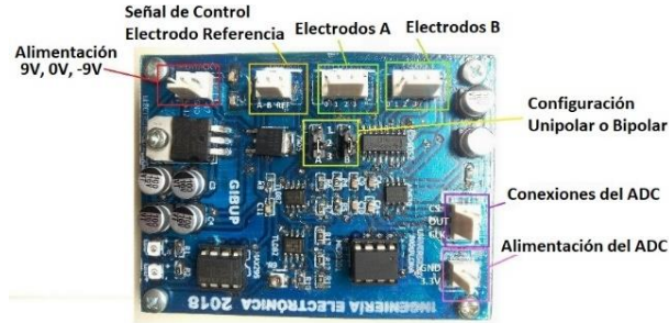
Figura 7. Diseño electrónico para adquisición de Señales EEG usando el software Eagle 8.0.1. Fuente: elaboración propia.
