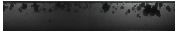
Figura 7. Patrón disperso, imagen obtenida por la cámara de alta velocidad a 1000 cuadros por segundo, con velocidades de superficie de J_w [m / s] = 0.800 y J_o [m / s] = 0.040.
