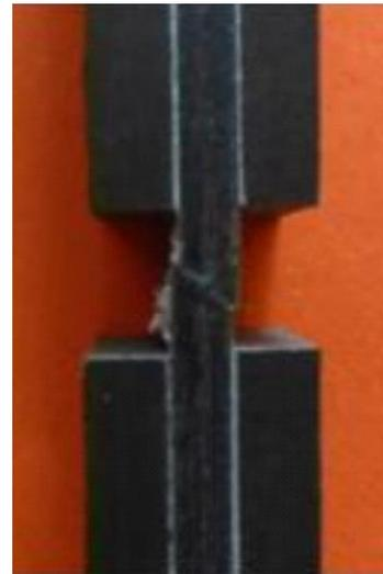
Figura 6. Falla por compresión compuesto de fibra de carbono a  $0^\circ$ . Fuente: [58].
