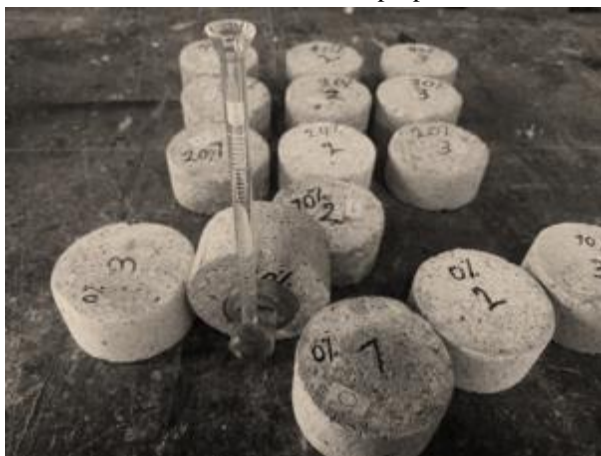
Figura 5. Ensayo de penetración de humedad por método RILEM [30]. Fuente: elaboración propia.
