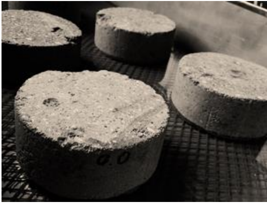
Figura 9. Análisis de eflorescencias en muestras de mortero. Fuente: elaboración propia.
