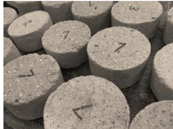
Figura 4. Pesajes de probetas cilíndricas con adición y sin adición de emulsión asfáltica durante ensayo de succión capilar. Fuente: elaboración propia
