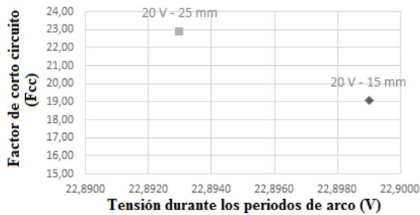
Figura 21. Variación del Fcc en función de la tensión durante los periodos de arco. Fuente: elaboración propia.
