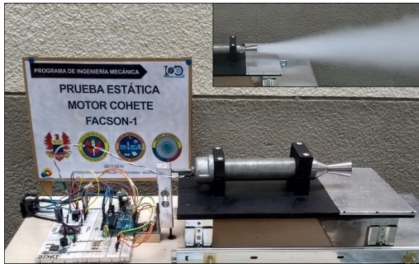
Figura 8. Montaje y prueba estática de combustión del motor cohete. Fuente: elaboración propia.
