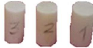
Figura 2. Selección de especímenes para los ensayos de compresión.
