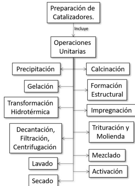
Figura 3. Operaciones unitarias para la preparación de catalizadores. Fuente: elaboración propia.
