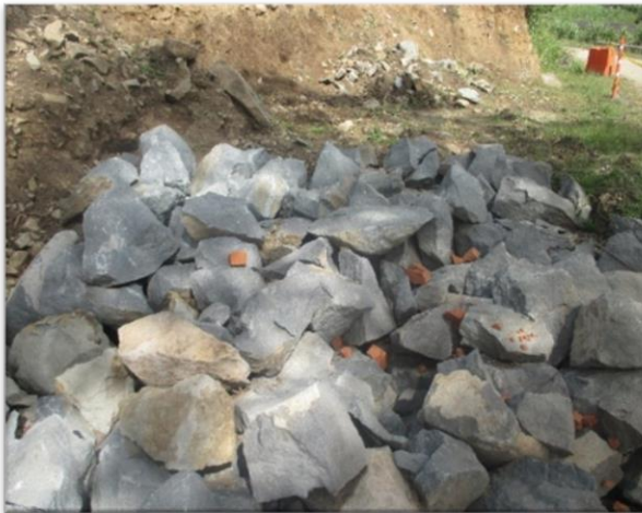
Figura 1. Fotografía de rajón utilizado para estabilización de suelos blandos. Fuente: elaboración propia.
