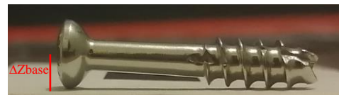
Figura 6. Desfase entre el tornillo y la hoja del patrón de calibración.
