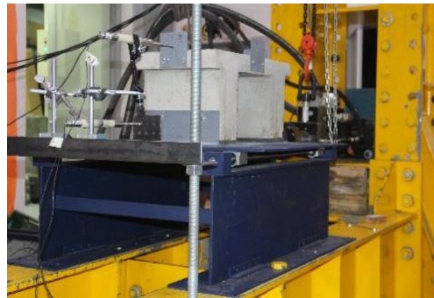
Figura 3. Implementación del ensayo en mesa vibradora. Fuente: [10].
