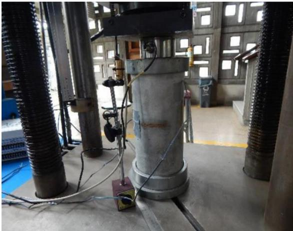
Figura 8. Montaje experimental en la máquina universal de ensayos. Fuente: elaboración propia.
