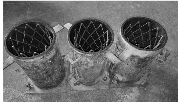
Figura 7. Elaboración de los cilindros de concreto reforzados con mallas de metal expandido. Fuente: elaboración propia.
