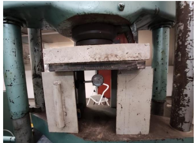
Figura 9. Montaje ensayo NTC 5721
