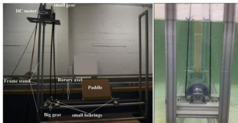
Figura 29. OWSC con PTO de transmisión mecánica. Fuente: adaptado de [46].
