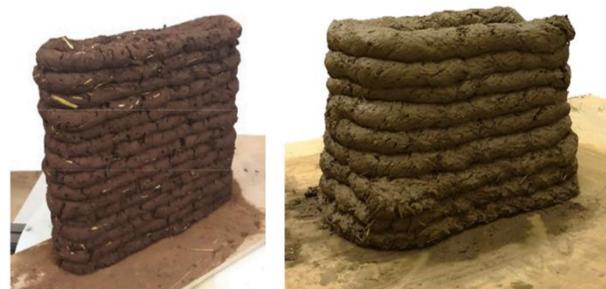
Figura 7. Impresión 3D de Cob [55].
