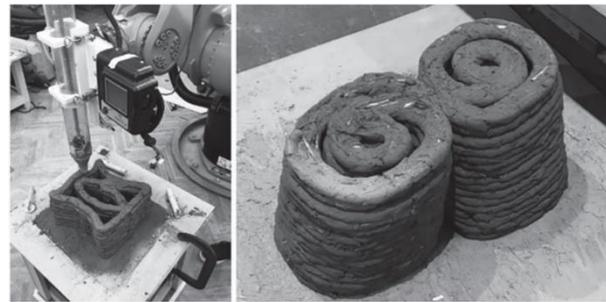
Figura 6. Impresión 3D de Cob [53].
