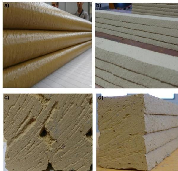
Figura 9. Cordones impresos y su sección transversal, boquilla circular (izquierda) y cuadrada (derecha) [61].
