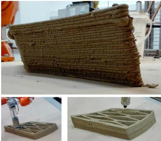
Figura 10. Impresión 3D de suelos y arcillas por: [66].
