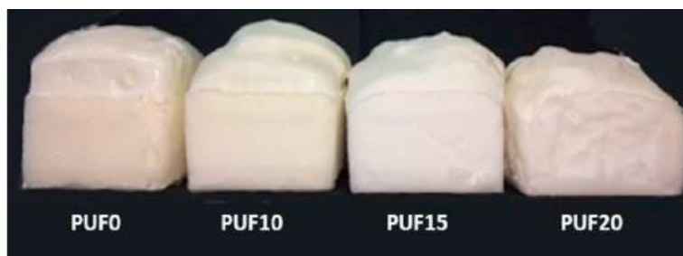
Figura 4. Espumas híbridas sintetizadas con polvo de PUR como agregado. Fuente: [50].
