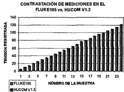
Figura 9. Contraste de las mediciones del equipo HUCOM V1.3 vs. Osciloscopio FLUKE 105.
