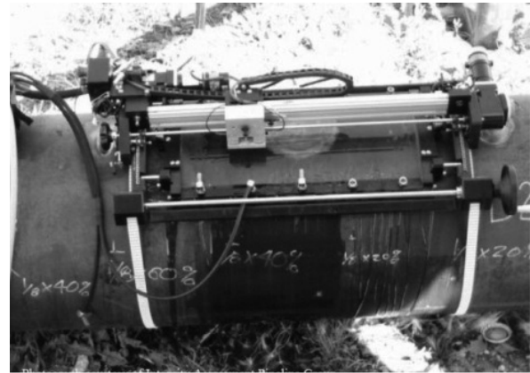
Figura 7. Sistema de Ultrasonido por inmersión. Fuente: [26].
