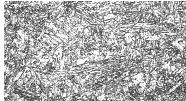
Figura 2. Microestructura del acero AISI-SAE 630, con tratamiento térmico, atacado con Villela. 200X
