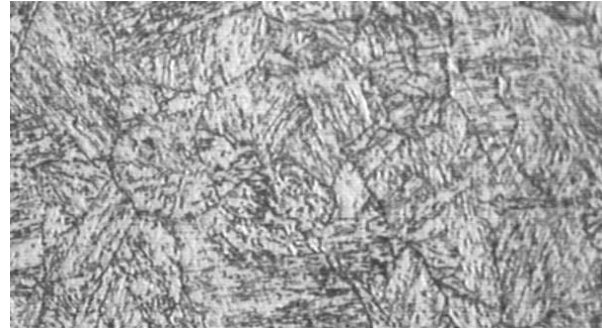
Figura 1. Microestructura del acero AISI-SAE 630, en estado de entrega, atacado con Villela. 200X
