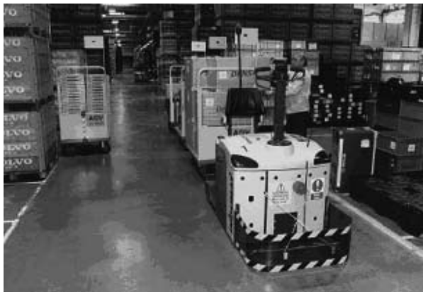
Figura 1. AGV Indumant Handimat aplicado en el transporte de productos en proceso en una línea de montaje Denso Manufacturing en Telford [2]
