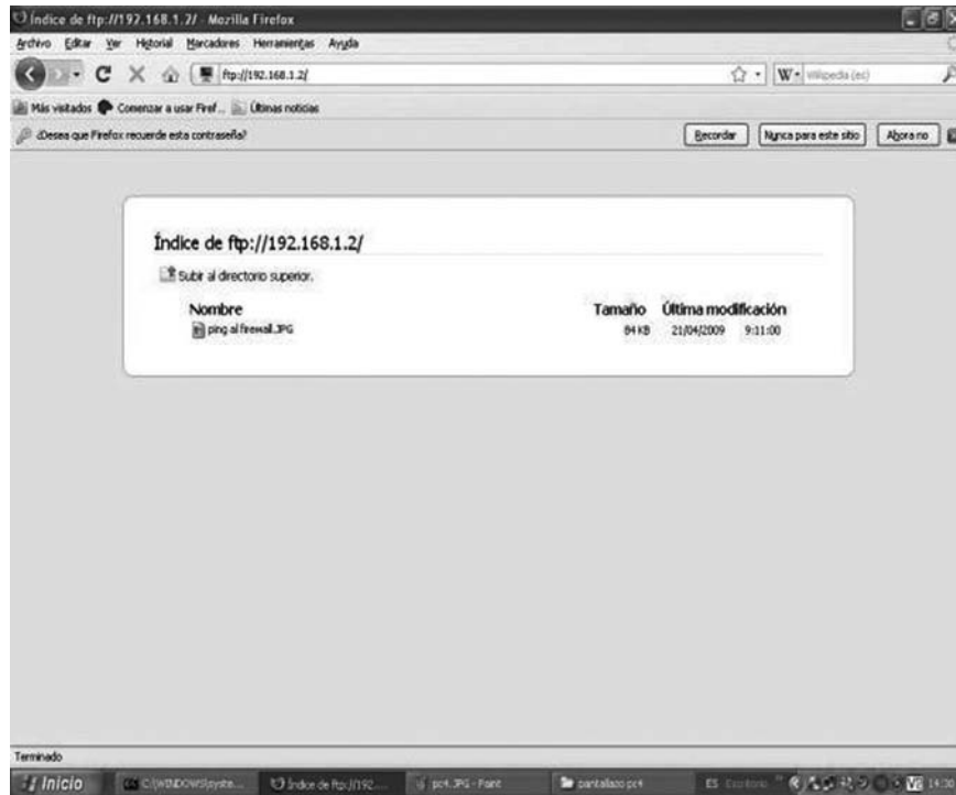
Figura 3. Acceso al servidor FTP desde PC4, en lo cual se ingresa desde el navegador con el protocolo FTP seguido de la ip donde se encuentra el servidor o el nombre de la página.
