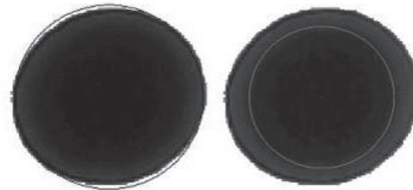
Figura 7. Radio exterior e interior de una Mancha. Con respecto a lo antes planteado se crea una tabla de Excel, como se muestra en la Tabla 1, donde se guarda el nombre y las características medidas de la mancha, más la información del TBN, viscosidad y hollín el cual es determinado mediante análisis infrarrojo en laboratorio.
