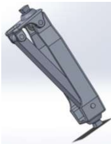
Figura 7. Articulación de rodilla para prótesis externa transfemoral.
