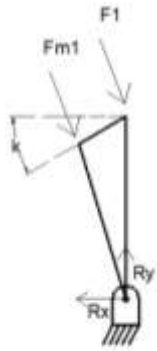
Figura 6. Componentes de fuerzas articulación de rodilla.
