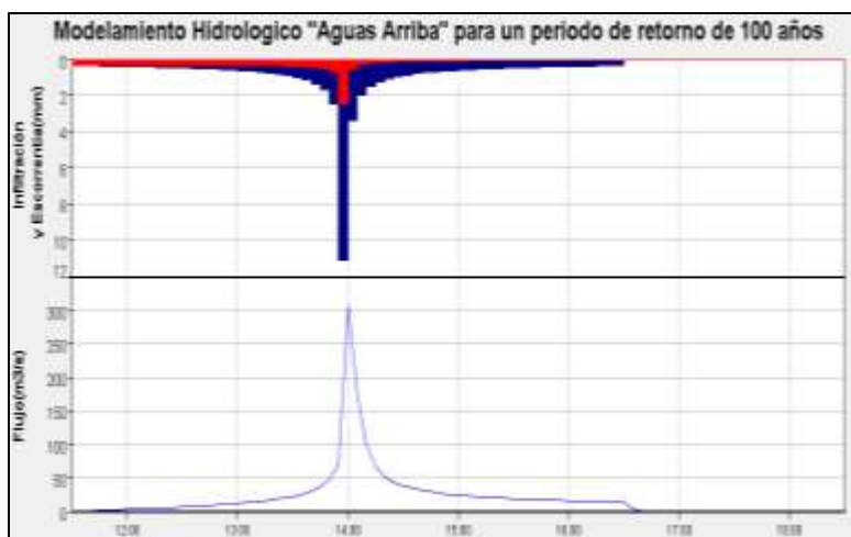
Figura 13. Hidrograma de crecida con un pico máximo de 306.8 m 3 /s para un periodo de retorno de 100 años y una duración de 7 horas.
