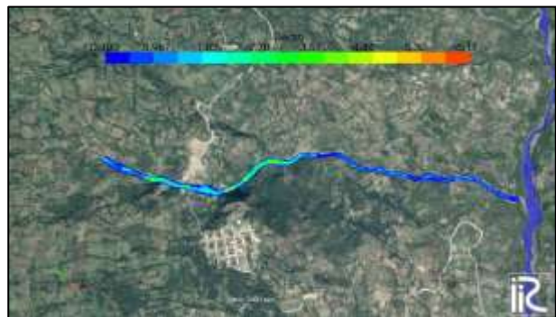
Imagen 6. Simulación dinámica de inundación máxima con un intervalo de precipitación de 2.61 horas y un periodo de retorno de 25 años.
