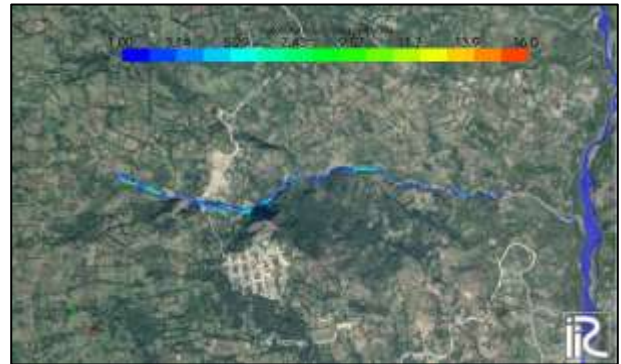
Imagen 9. Velocidad máxima del flujo para un periodo de retorno de 50 años y un intervalo de 2.61 horas de precipitación.
