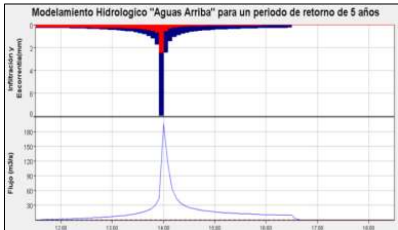
Figura 10. Hidrograma de crecida con un pico máximo de 194.8 m 3 /s para un periodo de retorno de 5 años y una duración de 7 horas.
