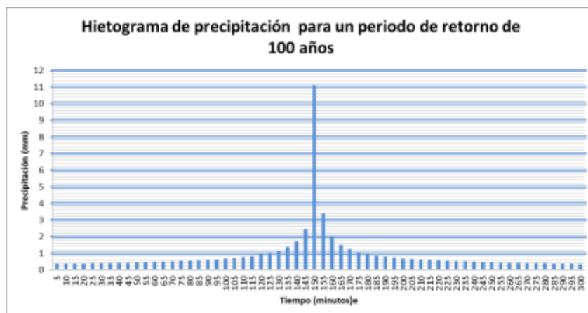
Figura 8. Hietograma de precipitación para un periodo de retorno de 100 años y una duración de 5 horas.
