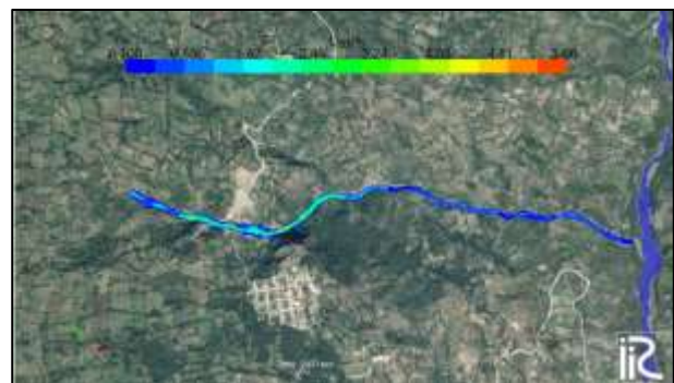
Imagen 4. Simulación dinámica de inundación máxima con un intervalo de precipitación de 2.61 horas y un periodo de retorno de 5 años.
