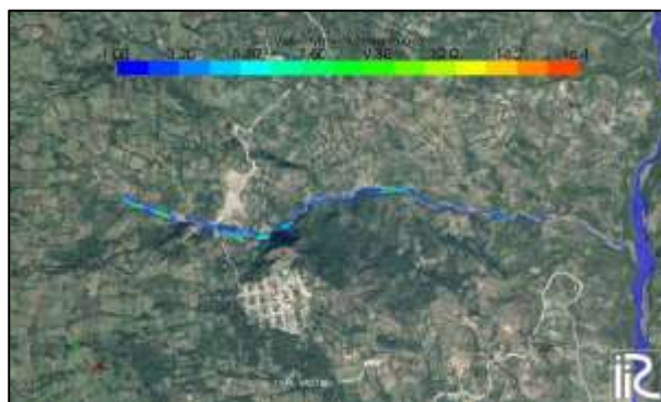
Imagen 11. Velocidad maxima del flujo para un periodo de retorno de 50 años y un intervalo de 2.61 horas de precipitación.
