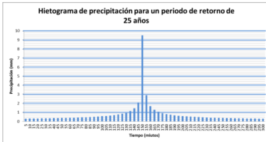
Figura 6. Hietograma de precipitación para un periodo de retorno de 25 años y una duración de 5 horas.
