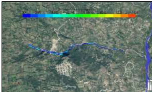
Imagen 3. Velocidad máxima del flujo para un periodo de retorno de 2.33 años y un intervalo de precipitación de 2.61 horas.
