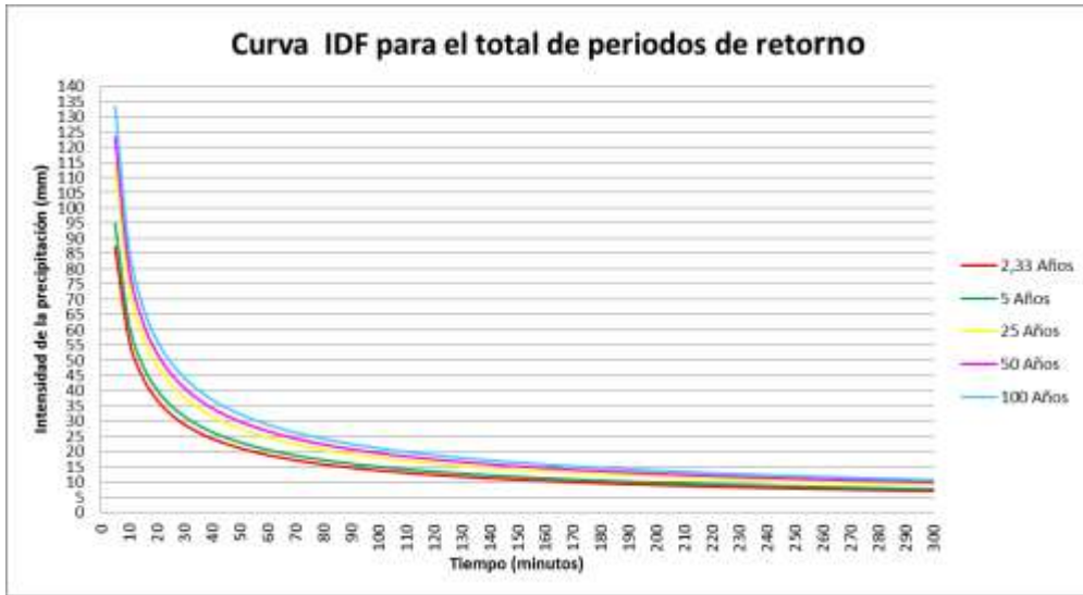
Figura 3. Curva de Intensidad Duración y Frecuencia (IDF) para los periodos de retorno de 2.33, 5, 25, 50 y 100 años con una duración de 5 horas de lluvia.
