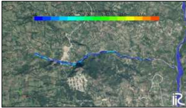
Imagen 7. Velocidad máxima del flujo para un periodo de retorno de 25 años y un intervalo de 2.61 horas de precipitación.
