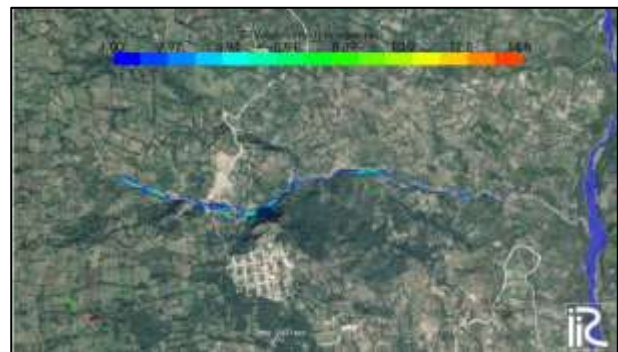
Imagen 5. Velocidad máxima del flujo para un periodo de retorno de 5 años y un intervalo de precipitación de 2.61 horas.
