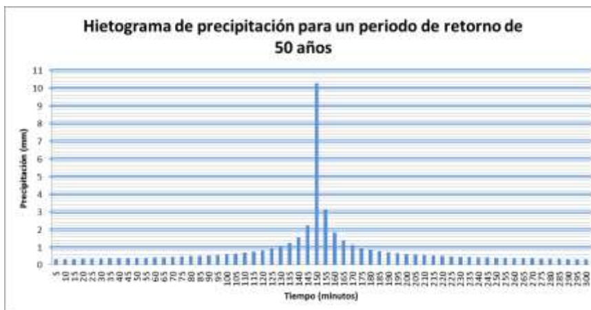
Figura 7. Hietograma de precipitación para un periodo de retorno de 50 años y una duración de 5 horas.
