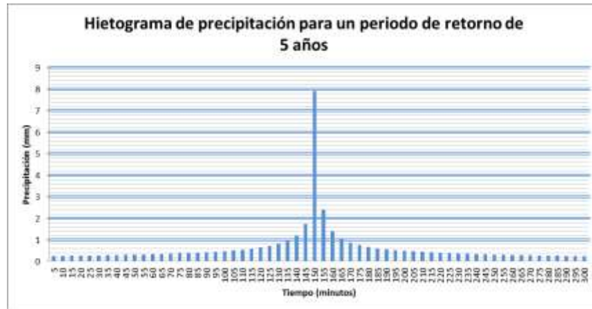
Figura 5. Hietograma de precipitación para un periodo de retorno de 5 años y una duración de 5 horas.
