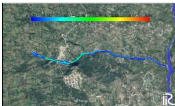
Imagen 2. Simulación dinámica de inundación máxima con un intervalo de precipitación de 2.61 horas y un periodo de retorno de 2.33 años.
