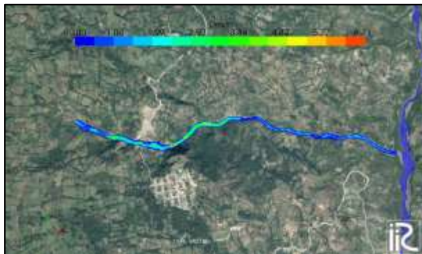
Imagen 10. Simulación dinamica de inundación maxima con un intervalo de precipitación de 2.61 horas y un periodo de retorno de 100 años.
