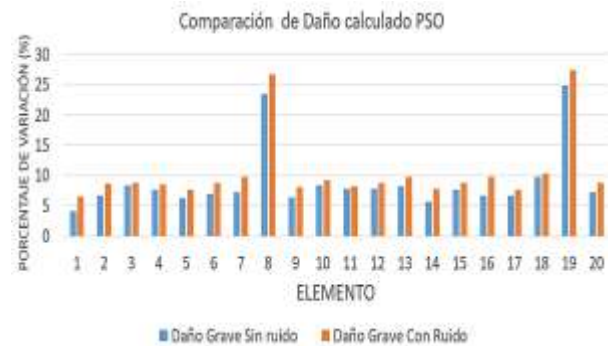
Figura 12. Porcentaje de Daño calculado PSO, con ruido y sin ruido, en escenario de daño grave, modo 6 de vibración, con dos elementos dañados.
