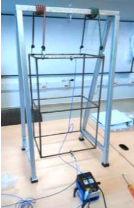
Figura 4. Estructura soporte con bandas elásticas.
