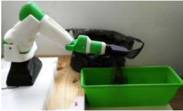
Figura 15. Robot vertiendo mezcla en las materas. Fuente. Elaboración propia.
