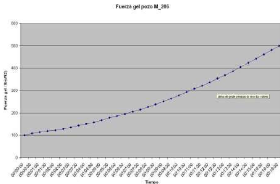
Figura 9. Desarrollo del esfuerzo de gel estático. Fuente: Prueba de Laboratorio.
