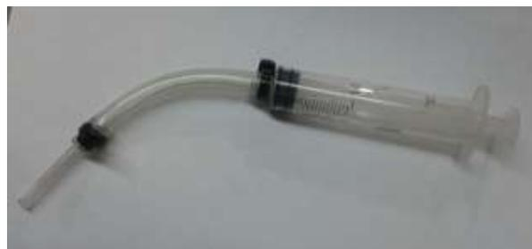
Figura 3. Dispositivo para dosificación del combustible.
