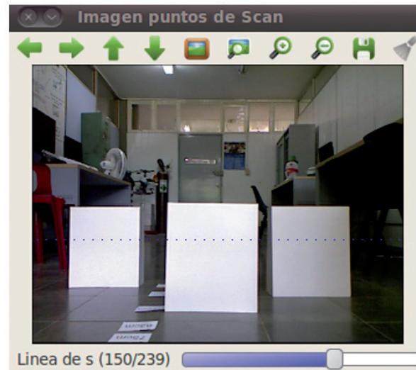
Figura 6. Puntos de escaneo para la adquisición de los valores de profundidad
