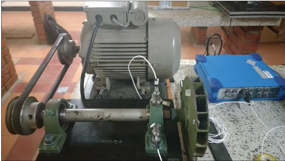
Figura 19. Montaje del de acelerómetros para el caso IV.
