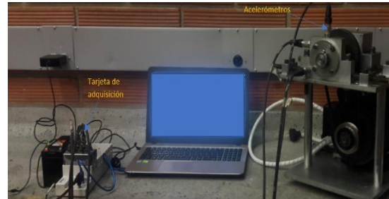
Figura 5. Fotografía del banco de pruebas con el sistema de adquisición. Fuente: elaboración propia.
