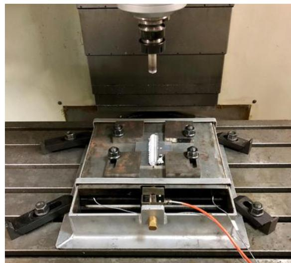
Figura 5. Dispositivo de medición de fuerzas desarrollado.
