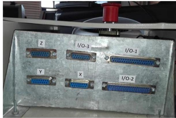
Figura 6. Conexiones para comunicación de datos con la fresadora. Fuente: elaboración propia.
