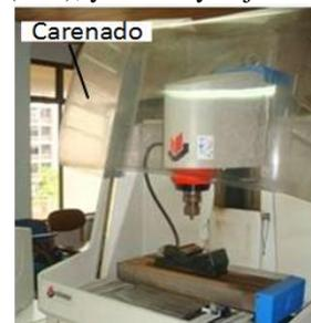
b) Carenado o cubierta de la fresadora
