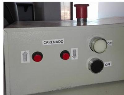
a) Botones para encendido (ON), Apagado (PFF), y subida y baja del carenado
