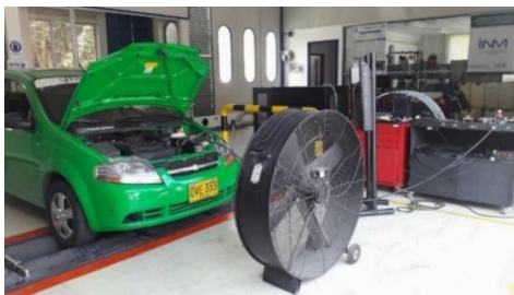
Figura 3. Vehículo en dinamómetro de rodillos (LPDA). Fuente: elaboración propia.
