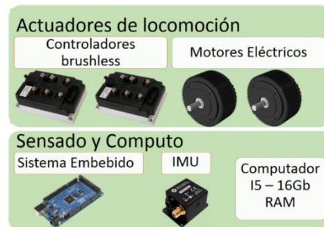
Figura 6. Hardware utilizado. Fuente: elaboración propia.
