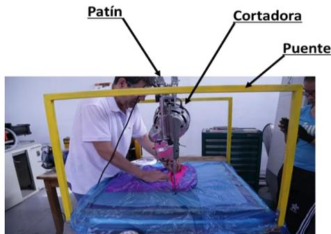
Figura 7. Prototipo del módulo de corte.
